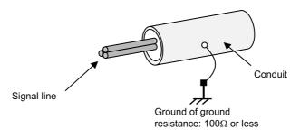
Fig. C.6 Wiring Example via a Conduit
