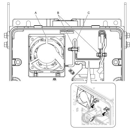
A - Circulation fan B - Hooks C - Fan cable
