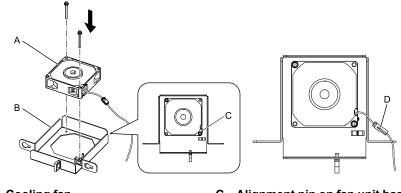
A - Cooling fan B - Fan unit base C - Alignment pin on fan unit base D - Circulation fan connector
