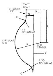
G112 Z(W)  $\cdots$  I  $\cdots$  K  $\cdots$  P  $\cdots$  Q  $\cdots$  R  $\cdots$ ;
