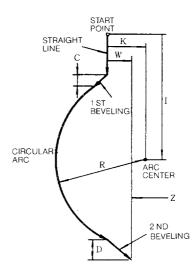
G112 Z(W)  $\cdots$  I $\cdots$  K $\cdots$  C $\cdots$  D $\cdots$  R $\cdots$ ;
