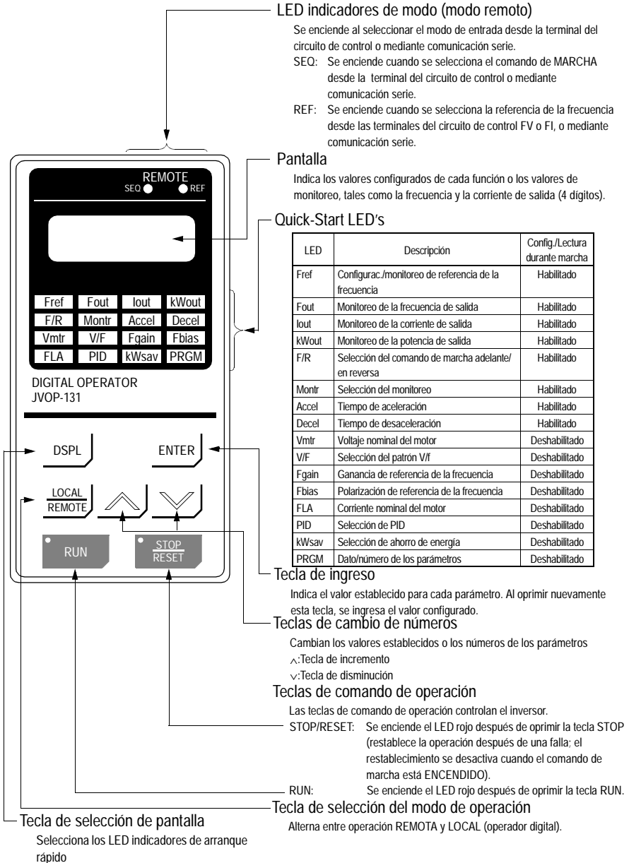
Figura 17 Pantalla del operador digital durante la energización
